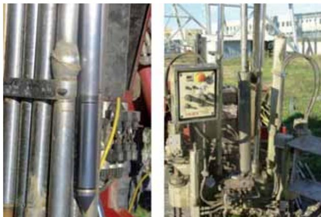
**Fig 3** - Foto della prova CPTu: particolare del piezocono e fasi del prelievo di campioni con campionatore Shelby
